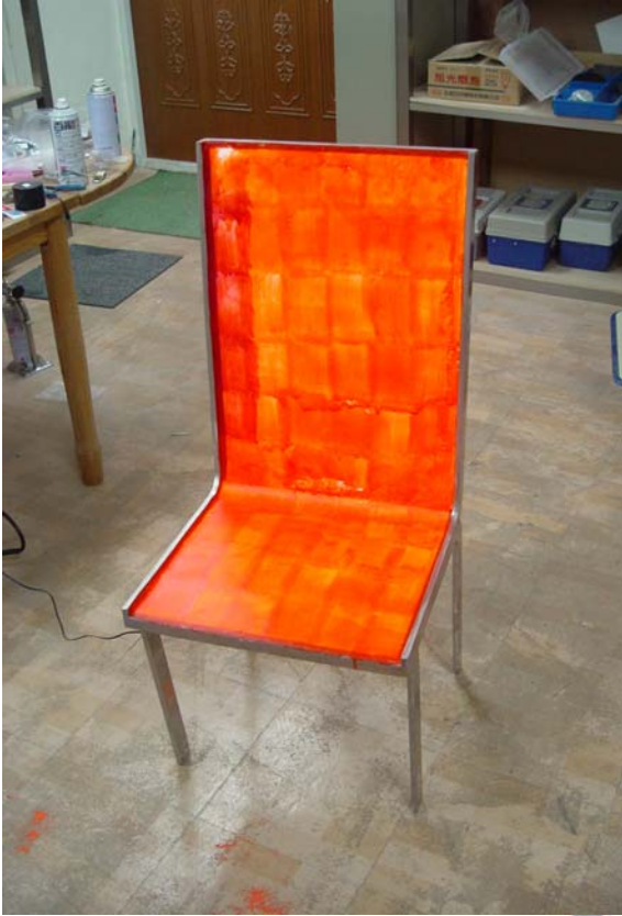
(圖 3.25) 冷光片發光 1 分鐘後的狀態。
