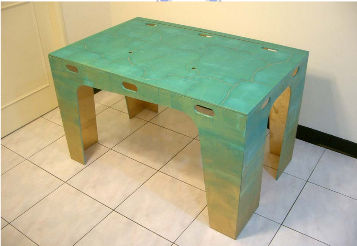
（圖 3.1）室溫 30°C 時，桌子顏色變淡的狀態。
