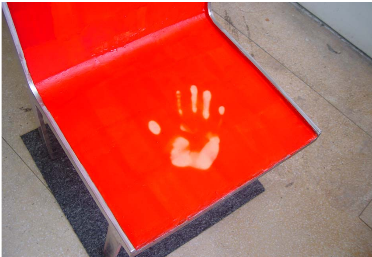
（圖 3.24）室溫 22°C 時，感應手掌體溫的狀態。
