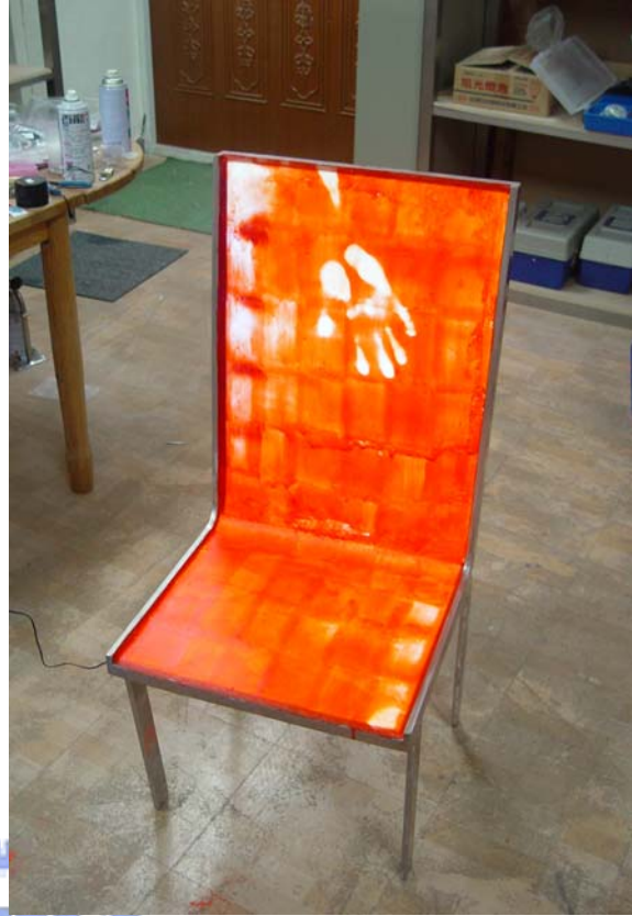
(圖 3.26) 冷光片發光 2 分鐘的狀態。
