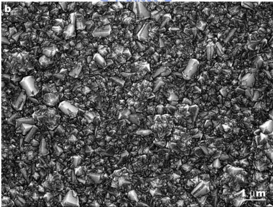
圖 3-42 (a)為{100} HOD 鑽石薄膜基材。(b)為高粗糙度多晶鑽石基材。
