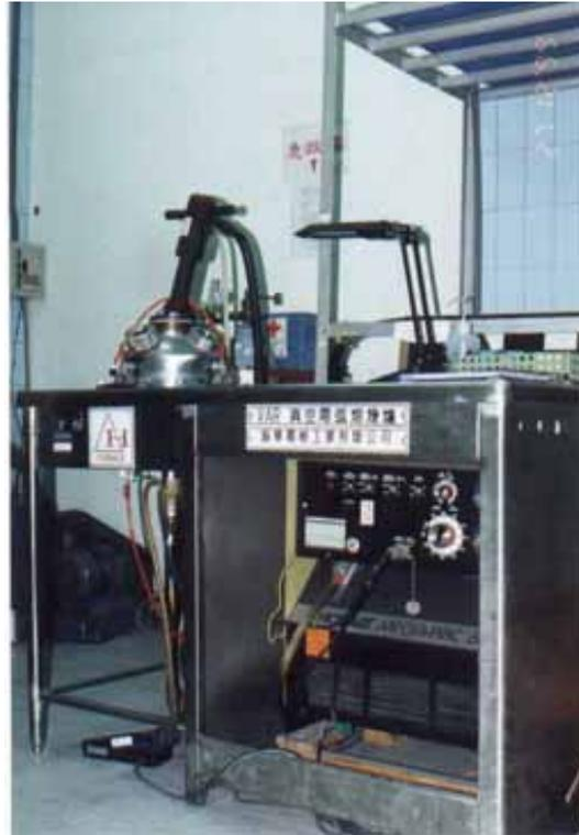
圖 5-1 台大材料所顧均豪教授實驗室的電弧真空熔煉爐。
