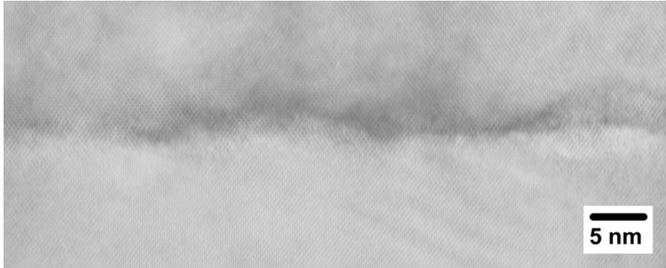
圖 3.12(a) 無原生氧化層之 n-型砷化鎵於 500°C 順相接合退火 2 小時之穿透式電子顯微鏡影像
