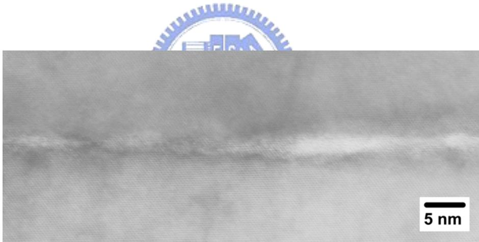
圖 3.12(b) 無原生氧化層之 n-型砷化鎵於 500°C 反相接合退火 2 小時之穿透式電子顯微鏡影像
