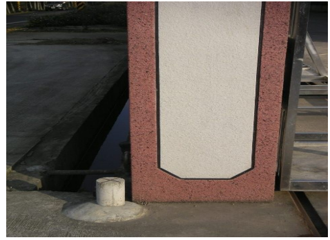
圖 42、儲槽沉陷測量後視高程用水準基點
