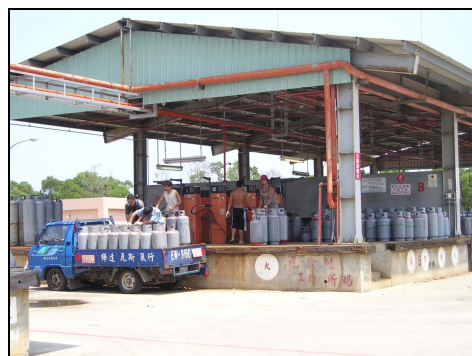
圖 50、分裝場灌裝台搬運鋼瓶上鋼瓶車作業情形
