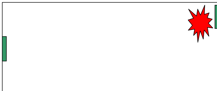
圖 3-18 起火點設於角落而有效出口設於中央之佈置圖
