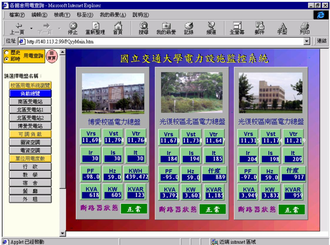
圖 42 電力設施監控系統圖
