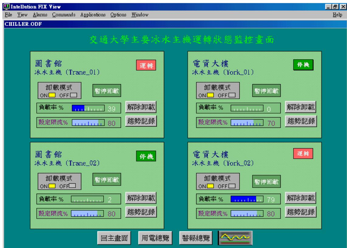
圖 45 冰水主機負載監控畫面
