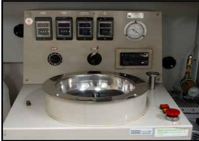
圖 3.3：旋轉塗佈機(Spin coater)
