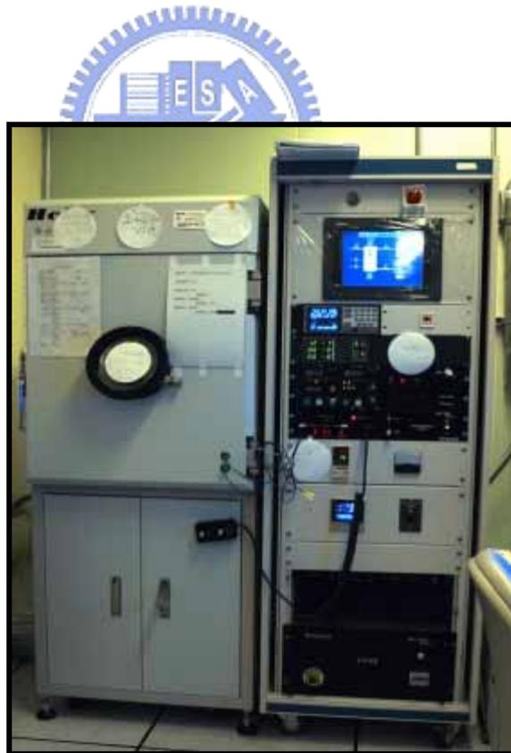
圖 3.8：蒸鍍機(Thermal evaporator)
