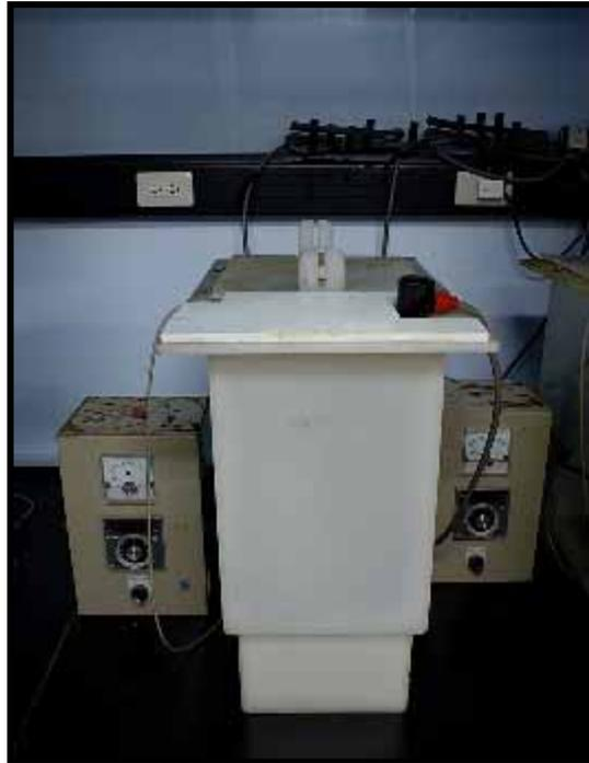
圖 3.9：銅金屬電鍍槽(Copper electroplating)
