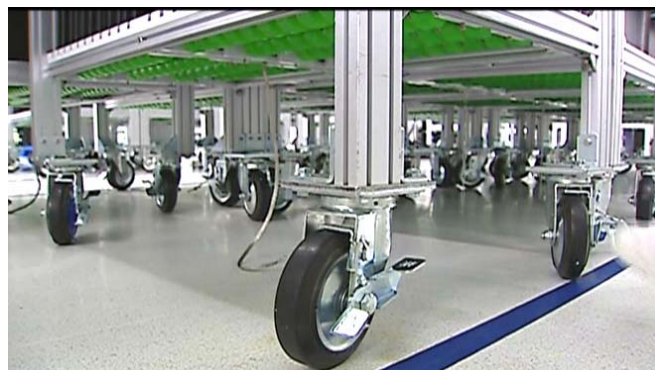
圖二十四：推車放置及剎車裝置示意圖
