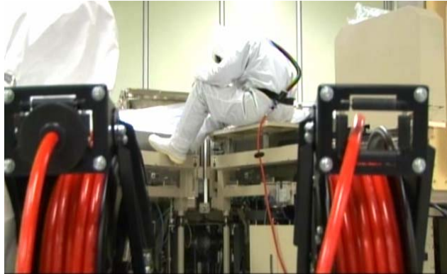
圖十八：乾蝕刻機台 PM 安全防護具示意圖
