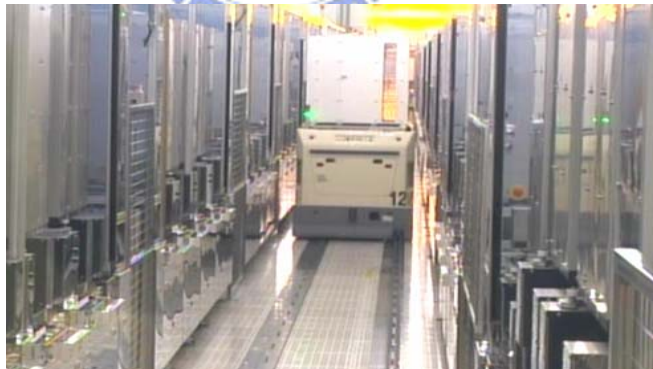
圖十九：Array 區 AGV 無人搬運車示意圖
