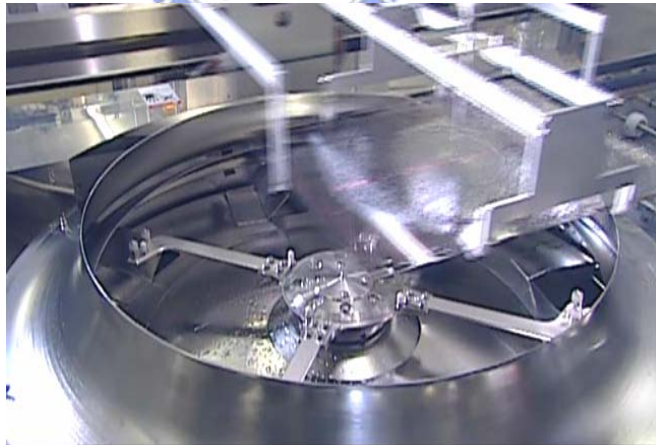
圖二：Thin-Film 區 玻璃洗淨及脫水乾燥圖
