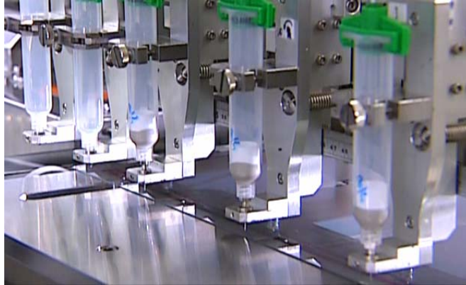
圖七：上框膠後加入液晶圖
