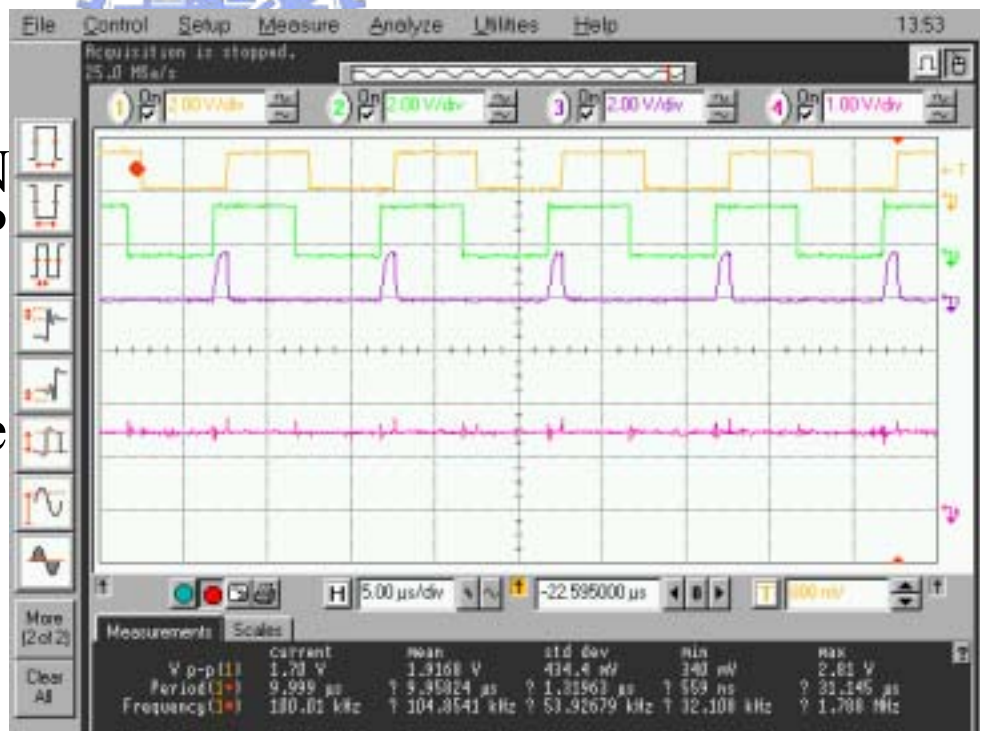
圖 105 量測 CKUP > CKDOWN 正脈衝圖
