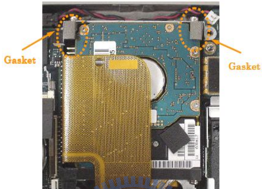
圖 2.34 硬碟的螺絲孔貼上導電布
