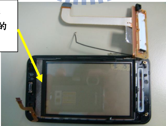
圖3.15 導電泡棉使LCD panel和Touch Lens及主板地接得更好
