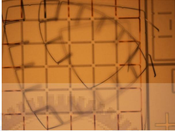
圖 50 退火後 DLC 層從樣品表面脫落
