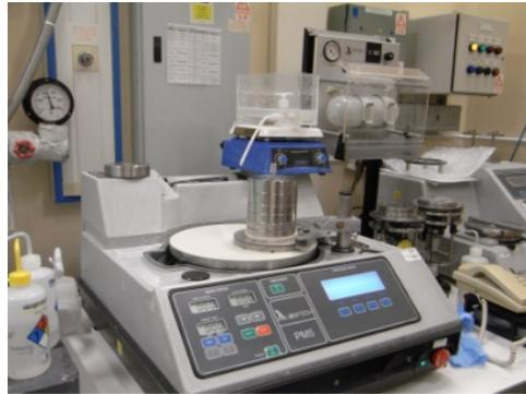
圖 34 Logitech PM5 CMP 設備
