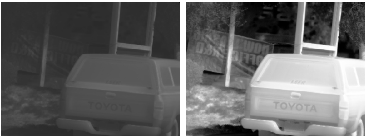
圖 3.5 左邊為原始的紅外線影像，圖中為一輛汽車，右邊為經過 HE 處理後的結果
