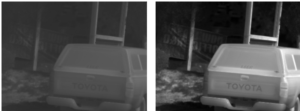
圖 3.8 左邊為原始的紅外線影像，圖中為一輛汽車，右邊為經過 BOHP 處理後的結果
