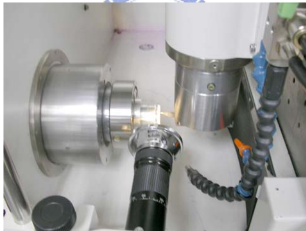
圖 3-14 使用長焦顯微鏡觀察鉋削微透鏡陣列時狀況
