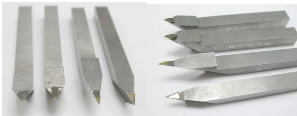
圖 4-13 進行微透鏡鉋削實驗時所使用的刀具外觀圖
