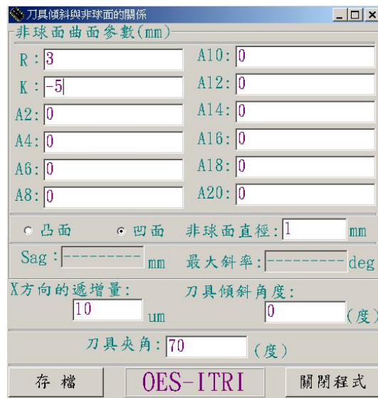
圖 4-16 計算鉋削透鏡時，刀具與透鏡切削接觸角度變化軟體主畫面
