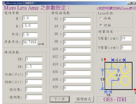
圖 3-9 鉋削微透鏡陣列的刀具路徑計算軟體的程式主畫面
