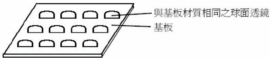
圖1-3以乾式離子蝕刻法將透鏡陣列形狀轉換至基板中
