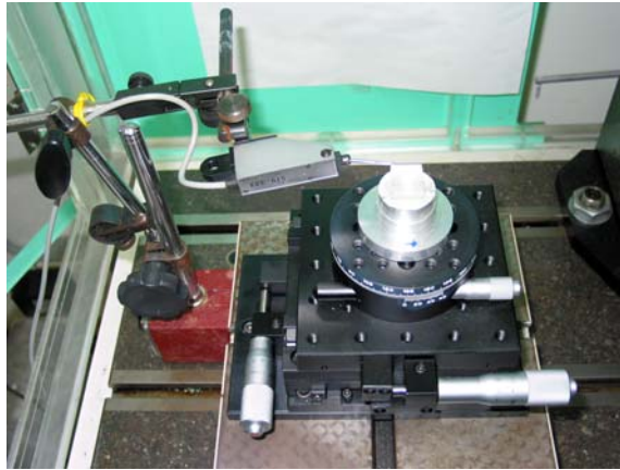
圖 4-11 使用旋轉平台調整透鏡 X 軸與探針的平行度
