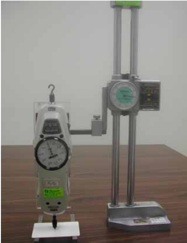
圖 34 IC 卡之彈簧常數 K 值量測
