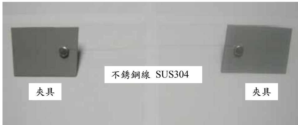
圖 47 拉伸彈簧的拉伸試片與夾具
