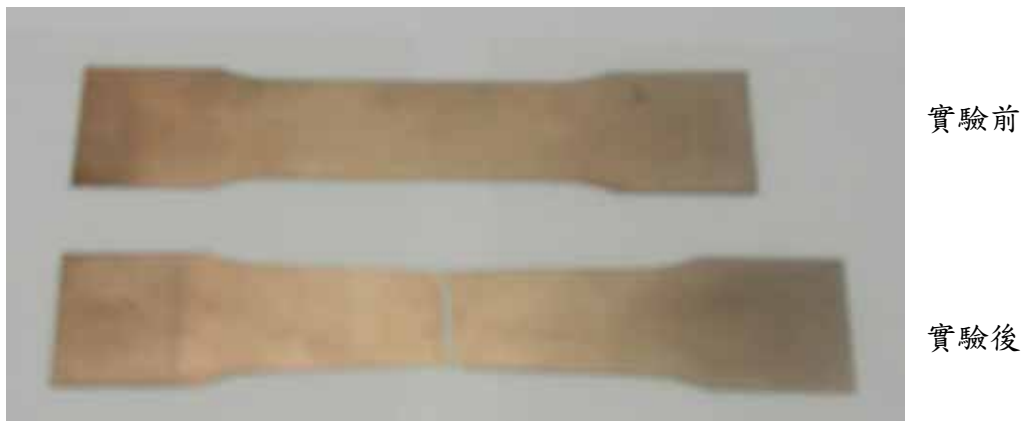
圖 50 IC 卡讀取頭端子的拉伸試片
