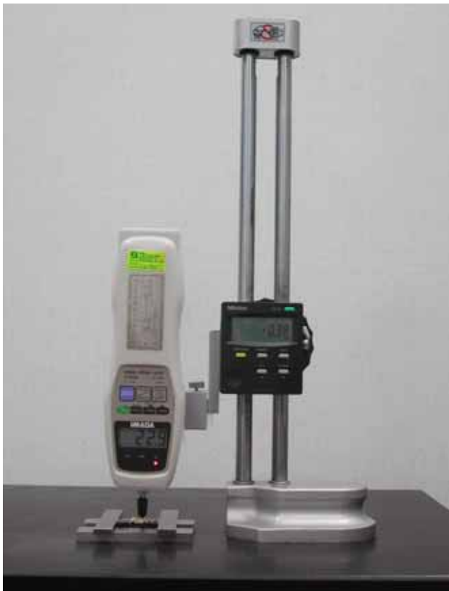
圖 31 IC 卡讀取頭端子之彈簧常數 K 值量測
