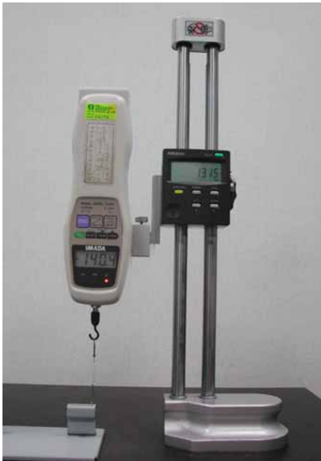
圖 44 拉伸彈簧之彈簧常數 K 值量測
