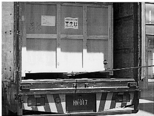
圖 4.6.1 機台運至科學園區，由承攬的搬運商將機台拉出承載卡車，以利堆高機作業。
