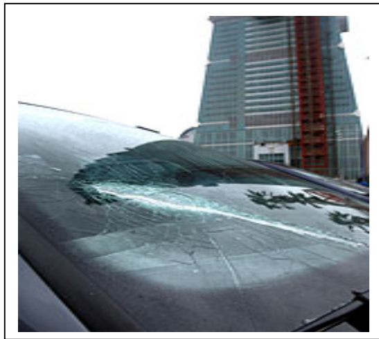
照片 5.23 塔樓 90F 鐵件飛落，損害地面之汽車
