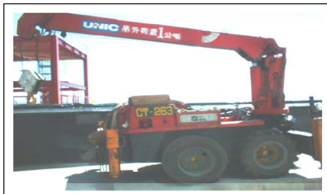
照片 5.24 墜落事故-塔樓未獲安檢合格之小型伸縮臂吊車。
