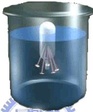
圖 1 調整浮沉子密度使其恰浮在液面
