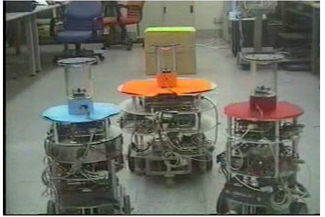
(b) Robot 1 開始朝預定目的地(黃色紙箱位置)前進，Robot 2 及 Robot 3 負責維持隊形。
