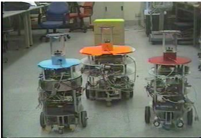
(c) 透過視覺回授及 RF 無線通訊協調功能，兩個 Slave 分別保持在 Master 的左後及右後方。
