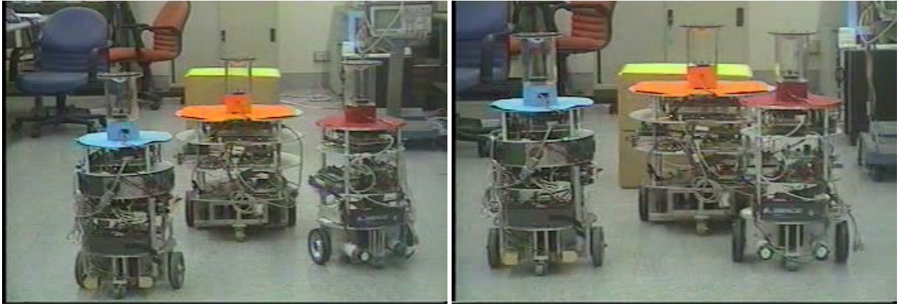
(g) 由於感測誤差, Robot 2 稍偏離其隊形軌道。(h) 透過視覺回授, Robot 2 修正回其隊形位置。
