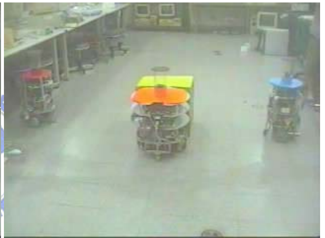
(d) 當 Robot 1 到達剛好接觸到的距離後停止 前進，並開始發送請求協助命令。
