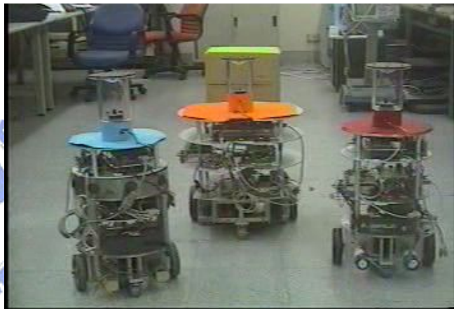
(d) 由於感測器的自然誤差，Robot 3 稍微偏離其隊形軌道。
