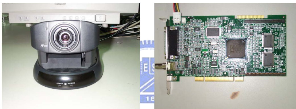
圖 4-4 (a) Sony EVI-D30 的攝影機 (b) MIL Lite 6.1(Matrox)的影像擷取卡
