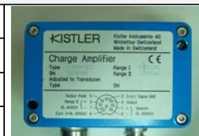
當量測到力量值經電荷放大器轉為類比的電壓值輸出後，為了可以在系統中做運算，必須將類比電壓數位化後才能讓電腦讀取並做處理，圖 2.8 為感測器的訊號處理流程，當類比電壓從電荷放大器送出時，透過 IOtech 公司的轉接卡 DBK201 將類比資訊轉換成數位資訊後，再 IOtech 研發的資料擷取卡 DaqBoard2005 來讀取其數位訊號，亦可利用其套裝軟體 Daqview 來觀測即時的電壓輸出波形，論文中使用其支援的程式語言 C/C++ 及應用程式介面 (Applications Program Interface, API) 來規劃軟體。
