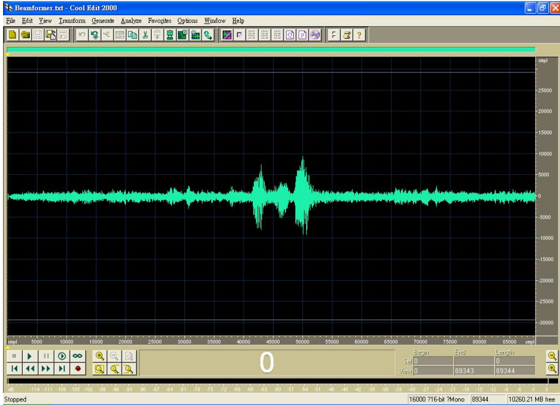
圖 5-8：測試一通過空間濾波器處理結果（濾波器階數=10）
