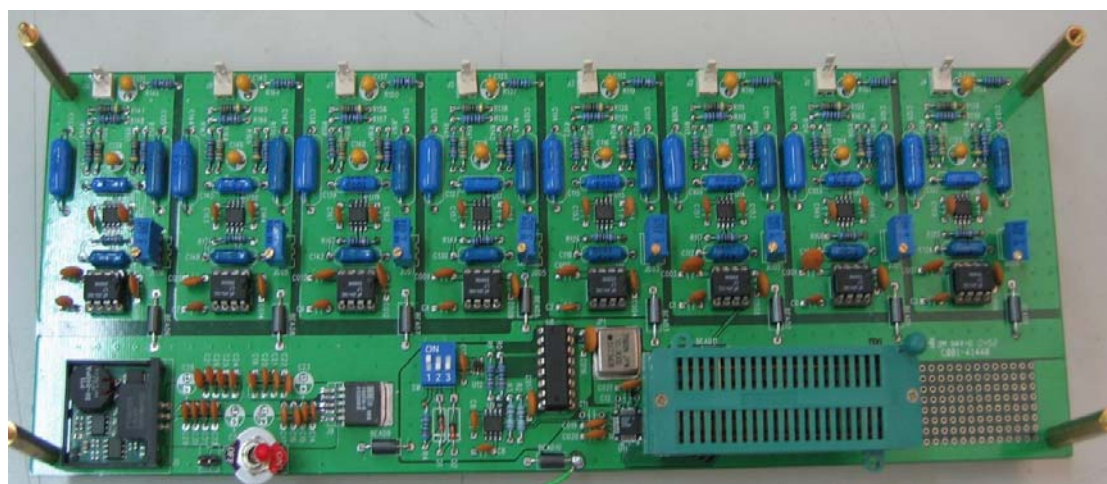
圖 4-6：麥克風訊號濾波器與數位/類比轉換電路板
