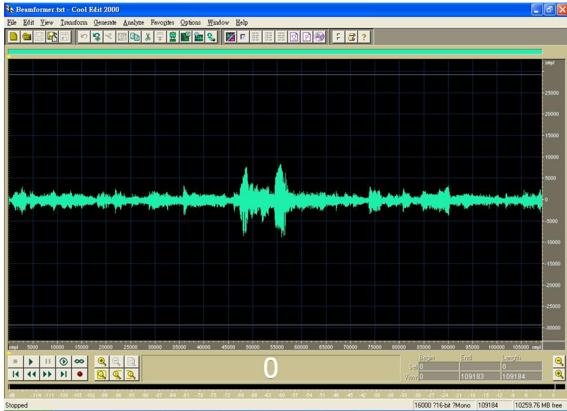
圖 5-11：測試二通過空間濾波器處理結果（濾波器階數=10）
