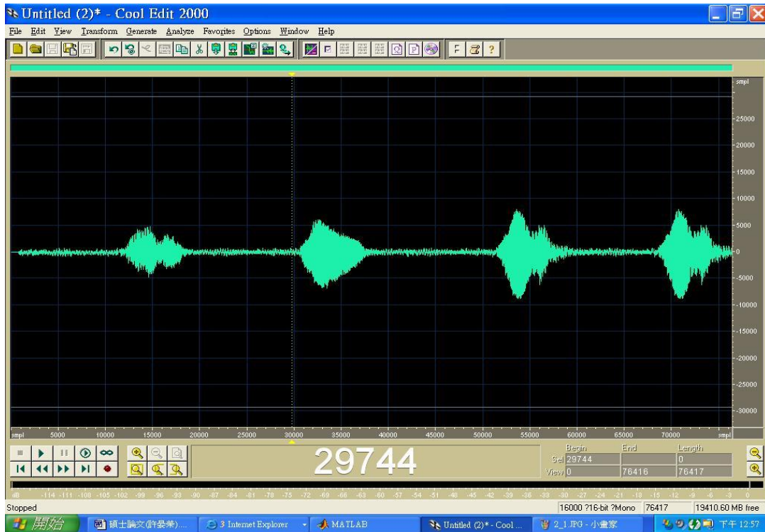
圖 2-15：真人語音與音樂混和訊號通過 Lower Beamformer 結果
