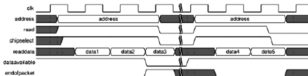
圖 3-12 串流時序之從架構讀取傳輸
