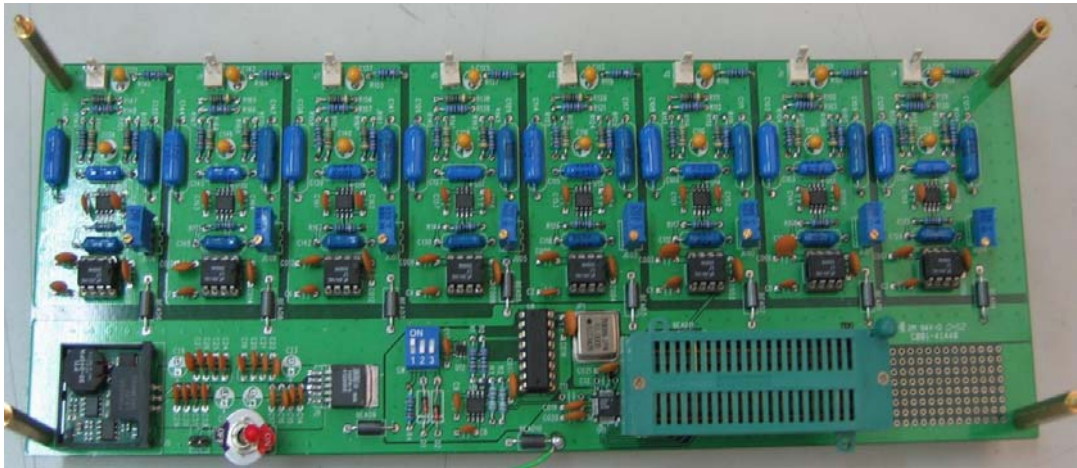
圖 3-6：麥克風陣列訊號擷取電路板
