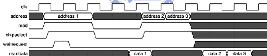
圖 3-11 固定間隔 (latency=2) 時序之從架構讀取傳輸
