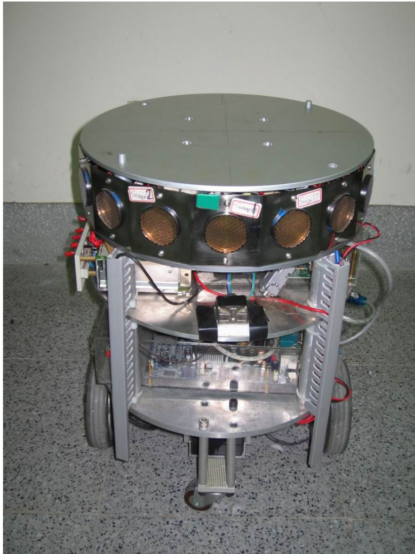
圖 4.1 實驗室自行研製之自走式機器人
