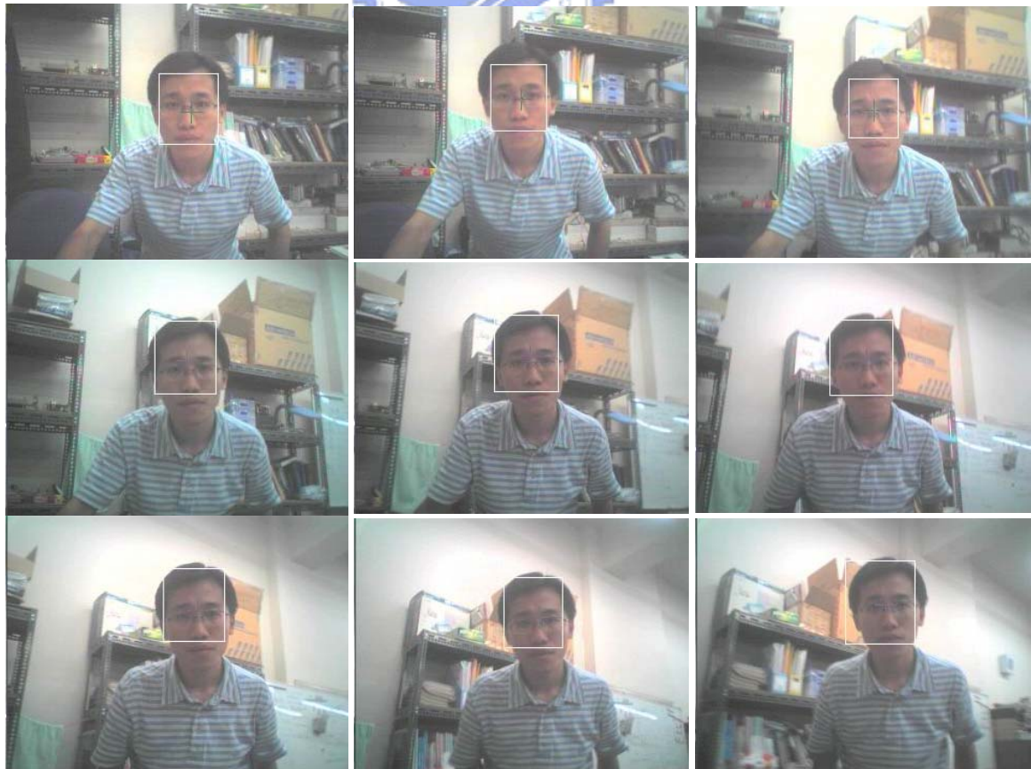
圖 5-4 機器人頭部左右及上下移動之追蹤結果
