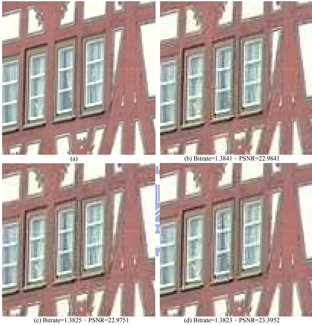
圖 5.5：圖片 2 視覺的細微比較 (a)表示原始影像放大圖 (b) 傳統壓縮使用 JPEG 的方法傳統壓縮(c)使用品質改良 JPEG[8] (d)本論文所提的方法。圖中的 PSNR 值為此部分影像的 PSNR 值非整張影像。
