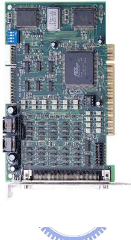
圖 2.15: PCI-8134 PCI BUS 運動控制卡 [11]
