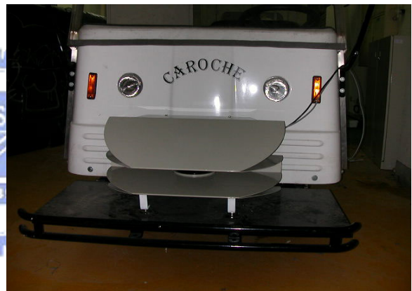
圖 3.3 裝置在車輛前方的雷射掃瞄器
