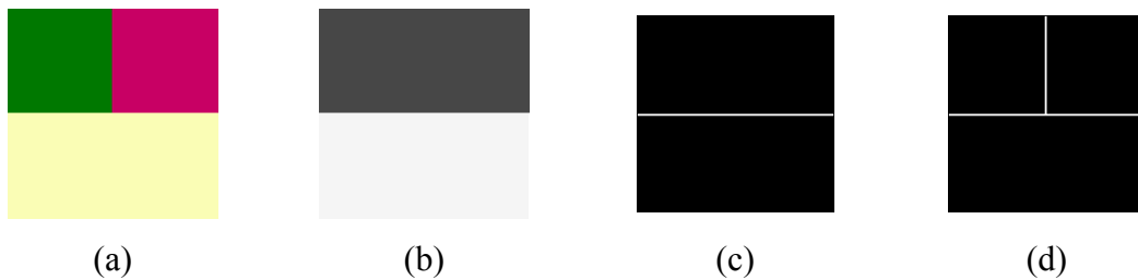
圖 2.9 應用邊緣檢測的結果。(a) 原始彩色影像；(b) 灰階影像；(c) 灰階影像的邊緣；(d) 彩色影像的邊緣。
