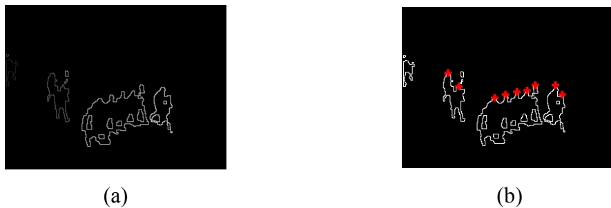
圖 1.3 利用連通邊界偵測行人的圖例。(a) 邊界影像；(b) 偵測出的行人。
