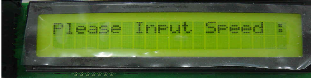
圖 5.7: LCD Display 顯示 "Please Input Speed :"
