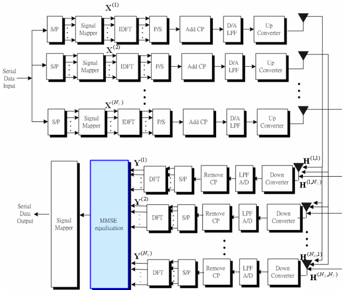
圖 2-10 MIMO-OFDM 與 MMSE 等化器方塊圖(以 N_T 根傳送天線與 N_R 根接收天線為例)
