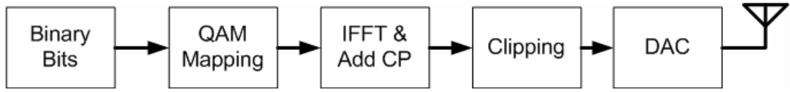
圖 3.2.1 OFDM 系統中傳送端考慮 Clipping 之方塊圖
