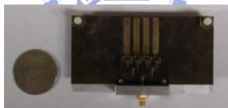
圖 3-6：1x4 共平面洩漏波天線陣列實體圖
