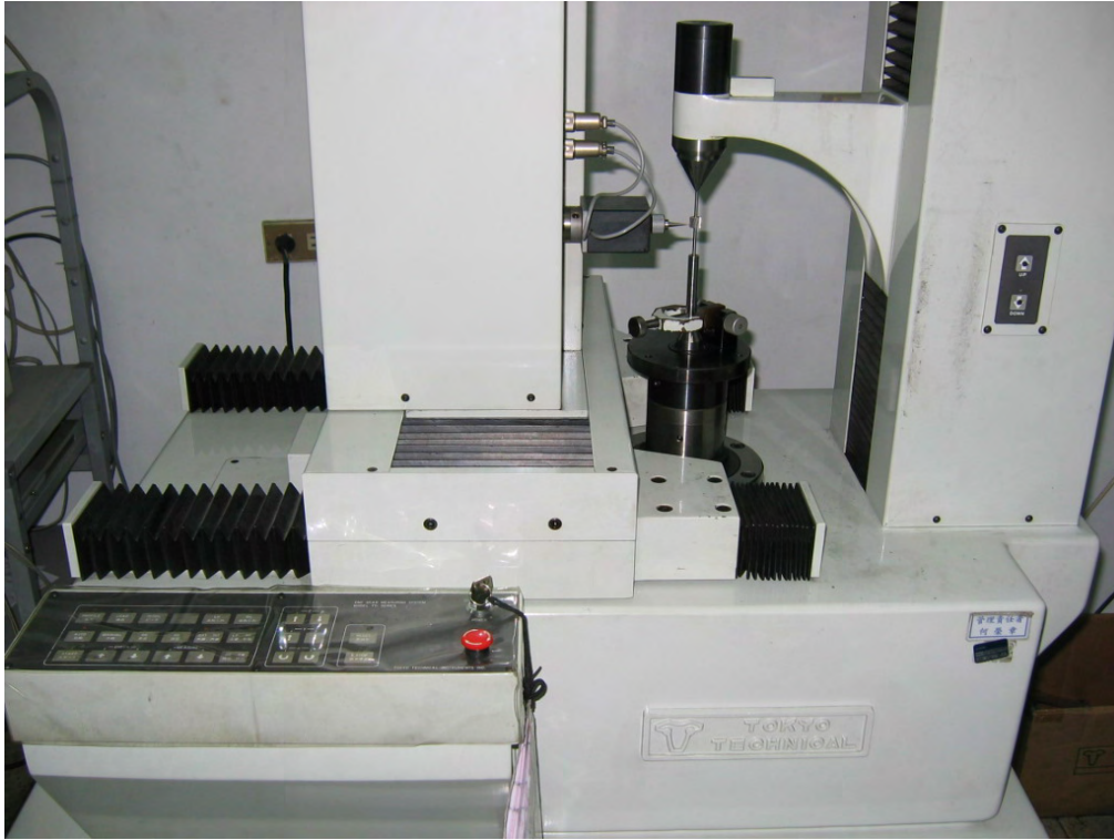
圖 4.5 TTI-300E-CNC 齒輪精度量測機
