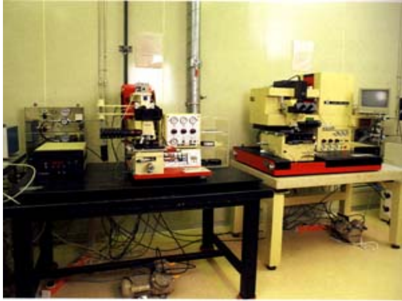
圖 2-13 Karl Suss 光罩對準曝光機
