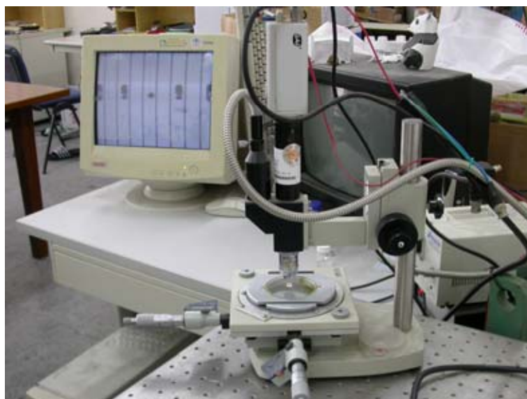
圖 4-31 CCD 顯微鏡與量測收縮量之螺旋測微儀
