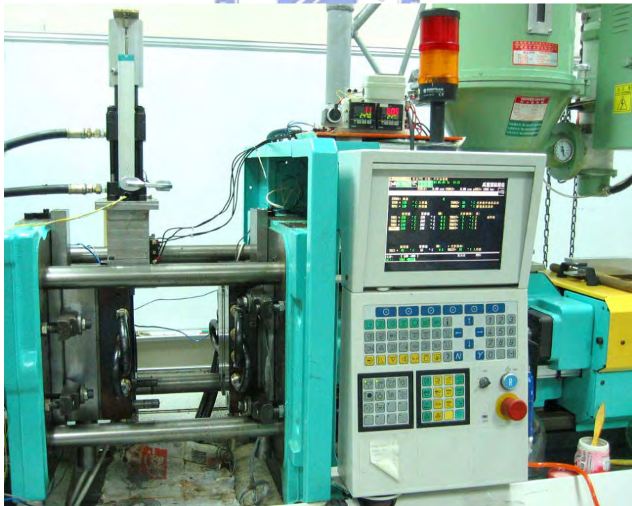
圖 3.12 安裝於射出機上之剪切試驗模具
