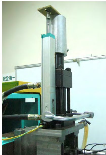
圖 3.5 位移計安裝位置
