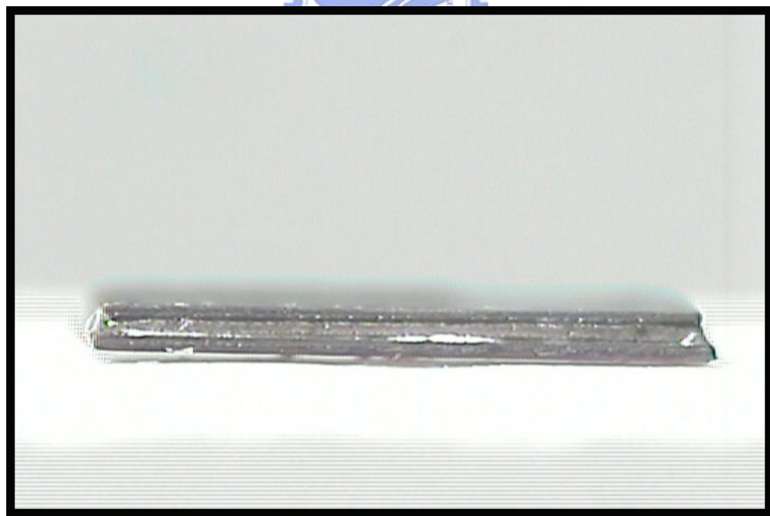
圖 4-37 氮氣保護下之玻璃粉與預氧化 Kovar 試片之接合情形
