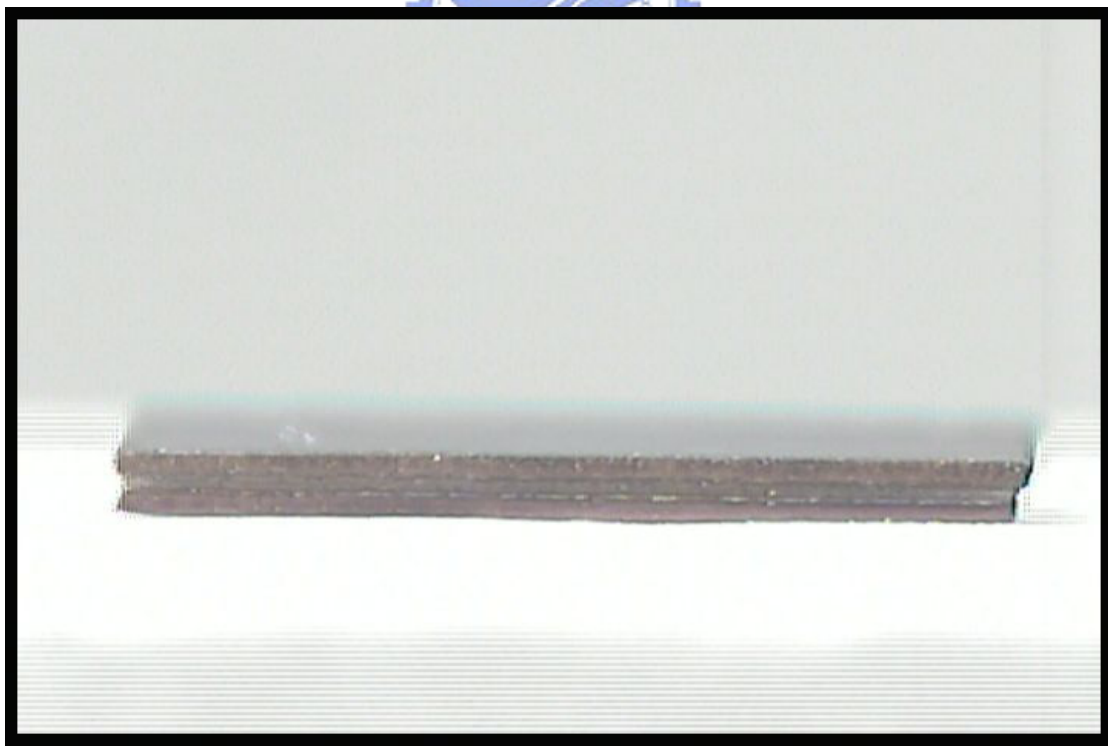
圖 4-36 氬氣保護下之玻璃粉與預氧化 Kovar 試片之接合情形
