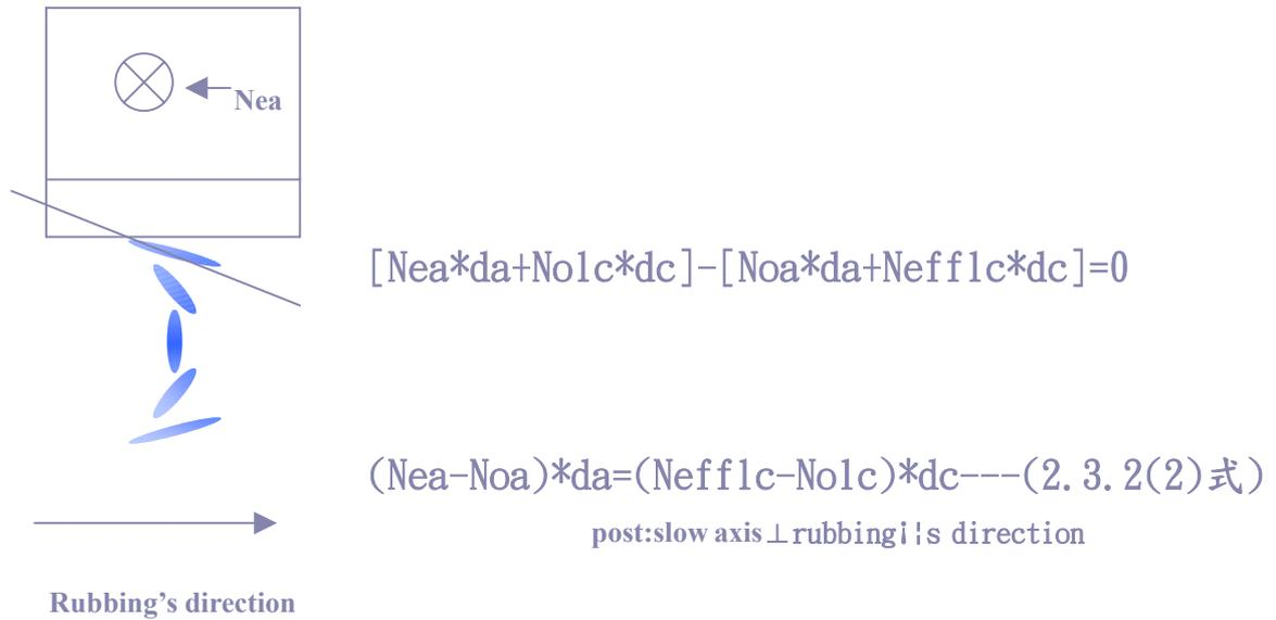
Fig 2-3-(C)為單光軸晶體的光軸軸向與 OCB cell 的 Rubbing direction 的相對關係
