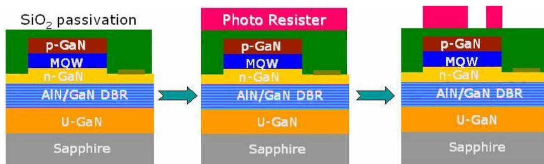
圖4-5f 第四道製程二氧化矽隔離層示意圖
