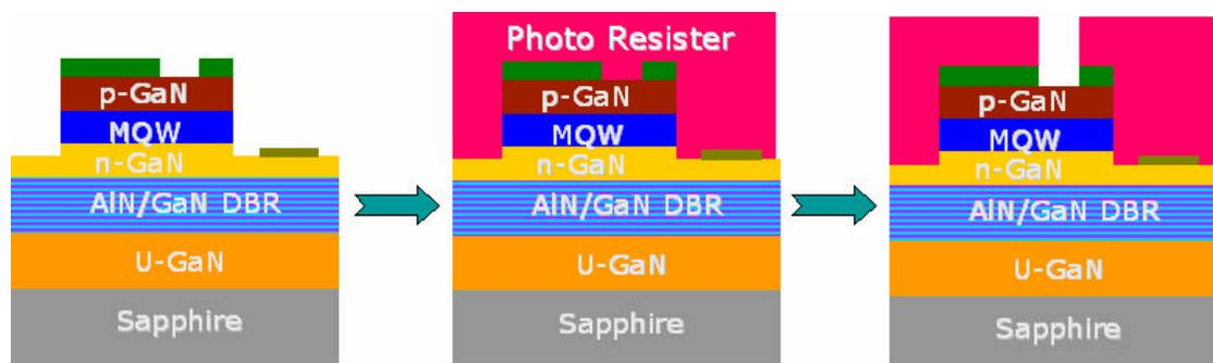
圖4-5h 第五道製程光阻塗佈示意圖
