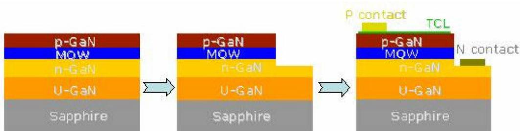
圖 5-3a LED 製程示意圖
