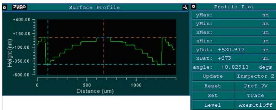
圖 4.29 Zygo 所測之八階繞射元件截面輪廓圖，高度為 530.912nm
