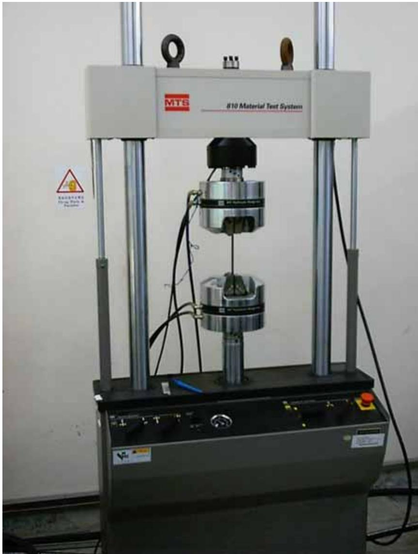
圖 2.2 MTS 萬能拉伸試驗機
