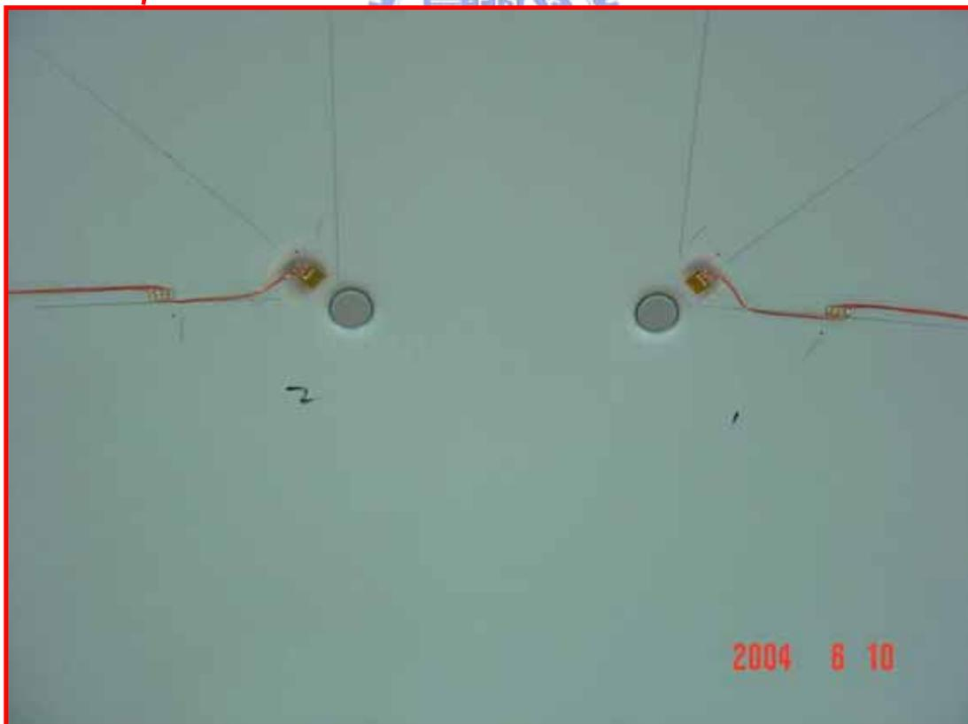
圖 3.3 應變規在碟盤上的位置圖
