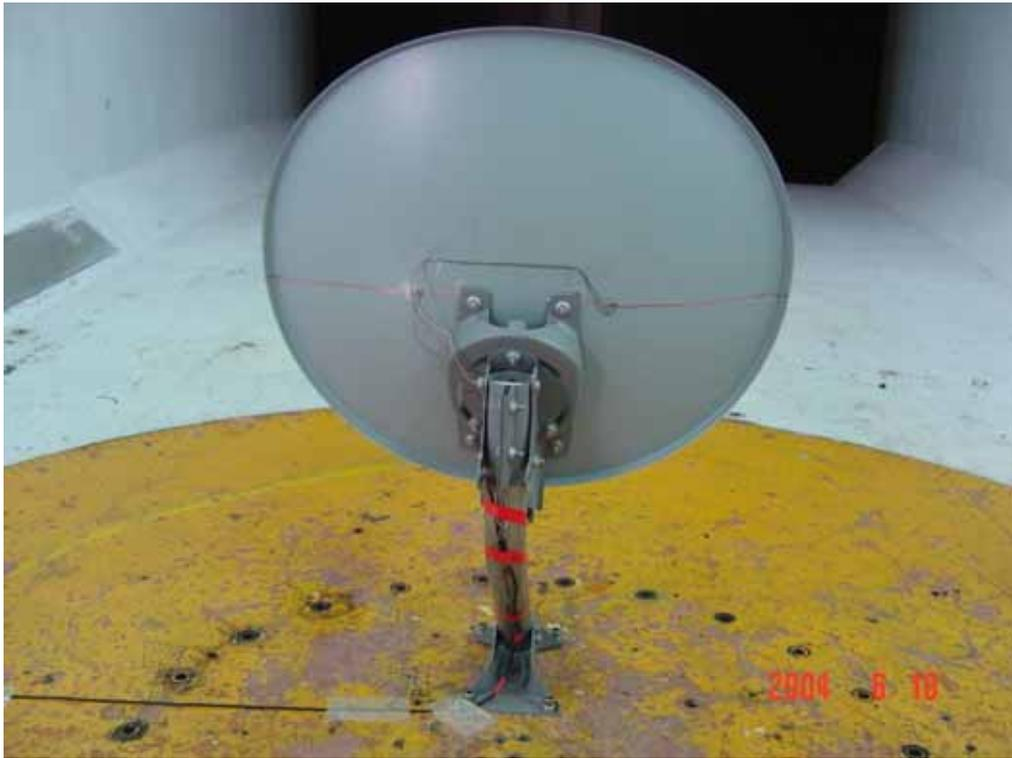
圖 3.1 碟形天線在風洞中架設的背視圖
