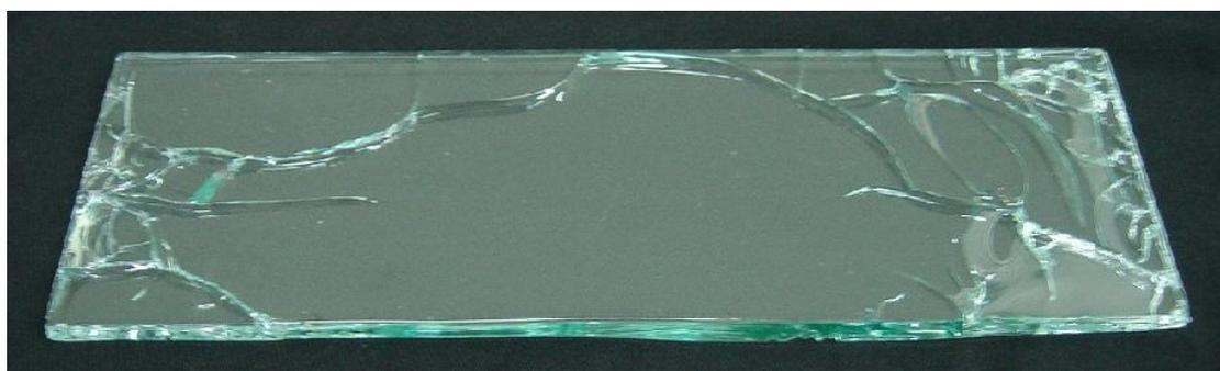
圖 51：Under treated 的玻璃試片
