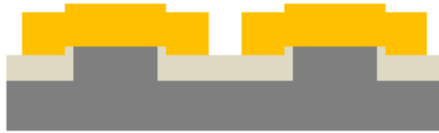
圖 4-7 鍍 P-type 電極金屬並 lift off
