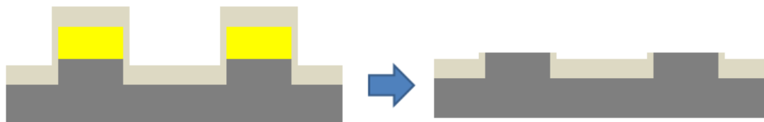
圖 4-5 \text{Si}_3\text{N}_4 沉積與 lift off
