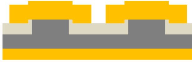
圖 4-8 磨薄並鍍 N-type 電極金屬
