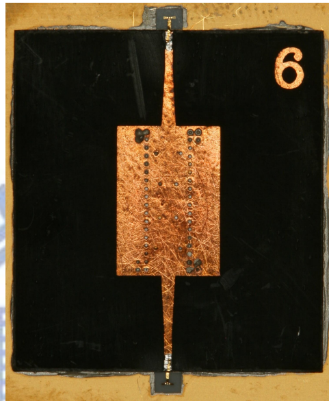
圖 4-16 中心頻 77.5 GHz 頻寬 3% 帶通濾波器實體電路
