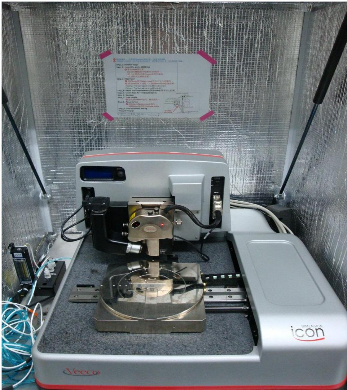
圖2-5 Veeco Dimension Icon 原子力顯微鏡量測系統
