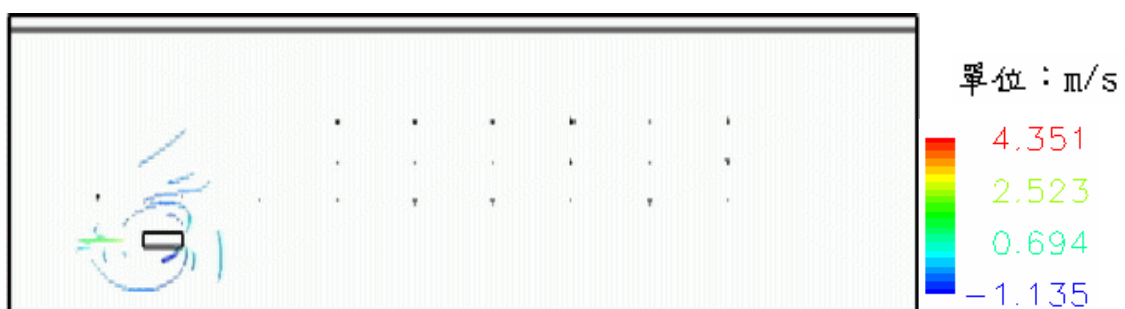
(b) 流場中固體粒子與氣流之運動情形 2
