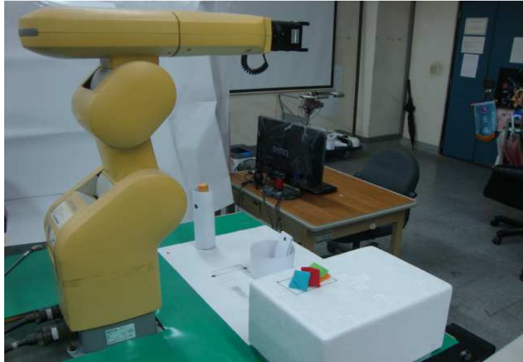
圖 4-13 人機搬運實驗工作場景，由右至左依序為沙包，籃子，靜態障礙物
