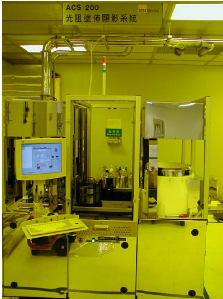
圖 2-4，自動化光阻塗佈及顯影系統(Track)。
