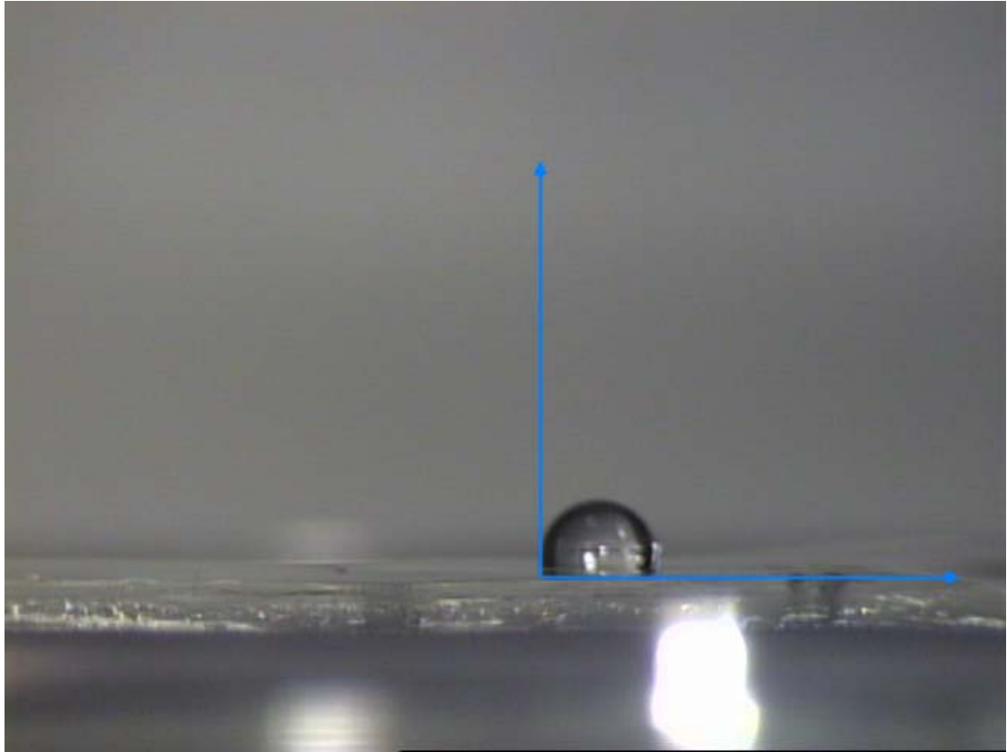
圖 2-8a，PDMS 打氧電漿之前，接觸角為 91.2 度。
