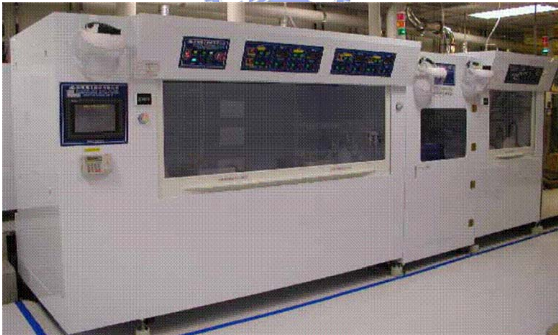
圖 2-2，濕式蝕刻清洗系統(Wet bench)。
