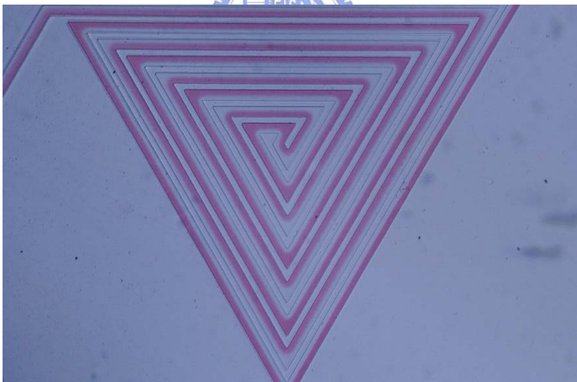
圖 3-11a，三角形微混合器， Re=0.01 。
