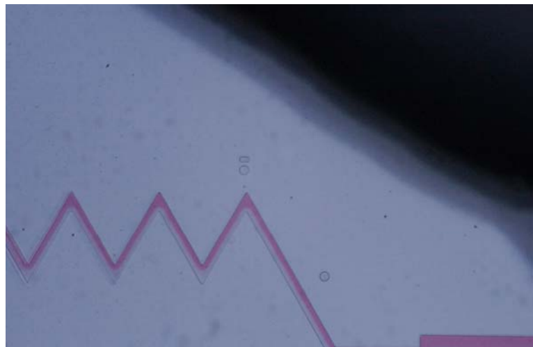
圖 3-3b，60 度轉角微混合器 Re=0.1 。
