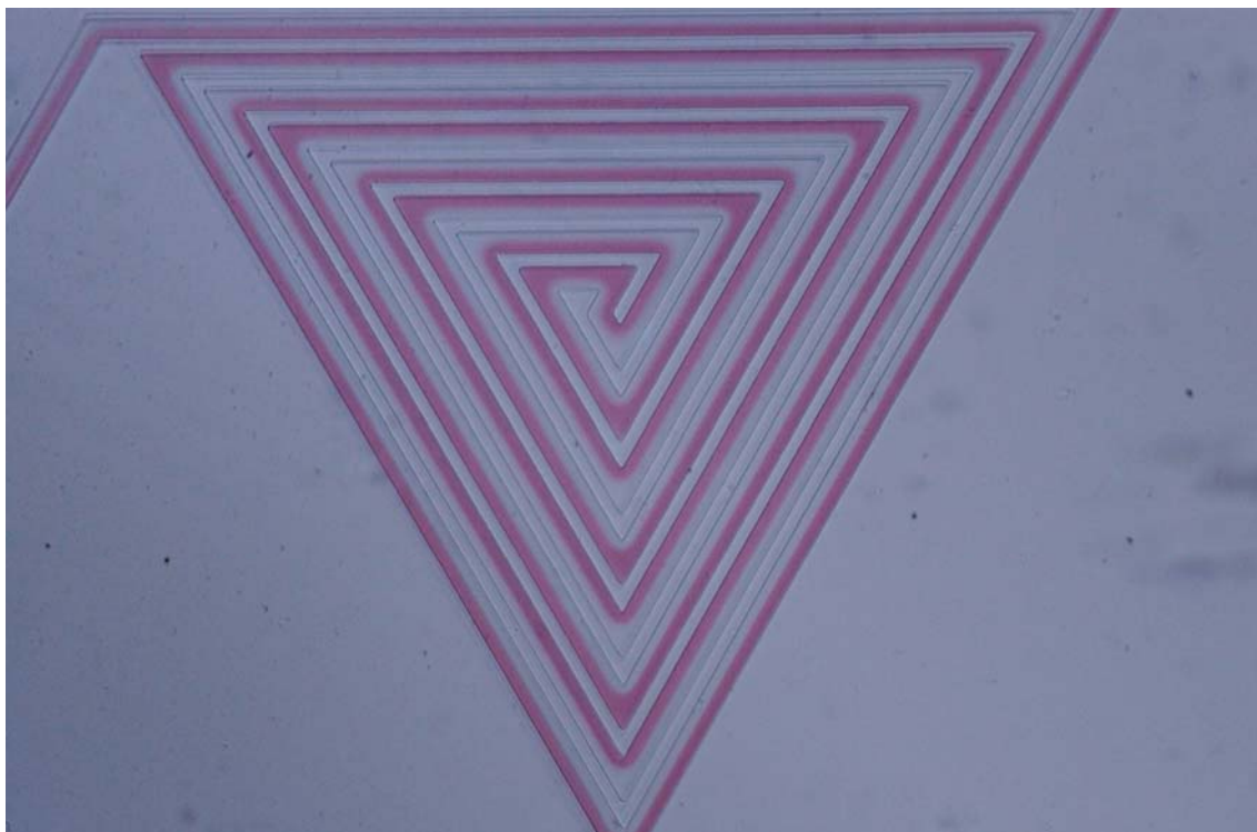
圖 3-11c，三角形微混合器， Re=1 。
