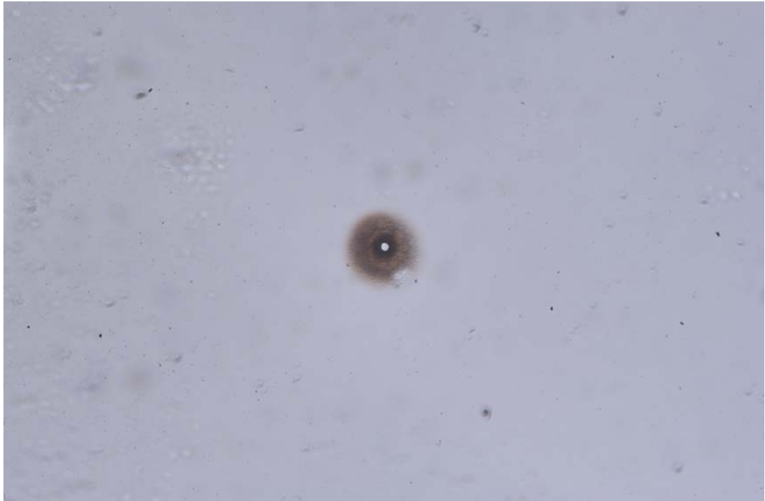
圖 3-15b，以 ArF 雷射打穿蓋玻片後之圖片。
