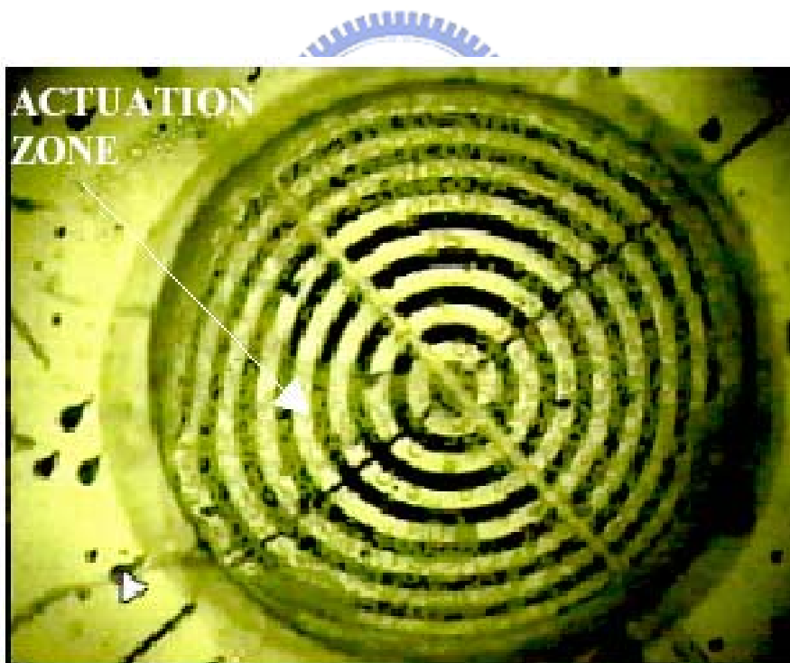
圖 1-2，Vibbu Vivek 等人設計出一聲波混合器。
