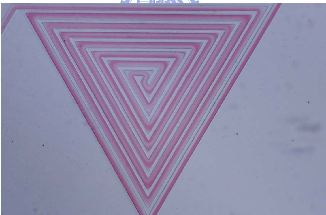
圖 3-11c，三角形微混合器， Re=1 。
