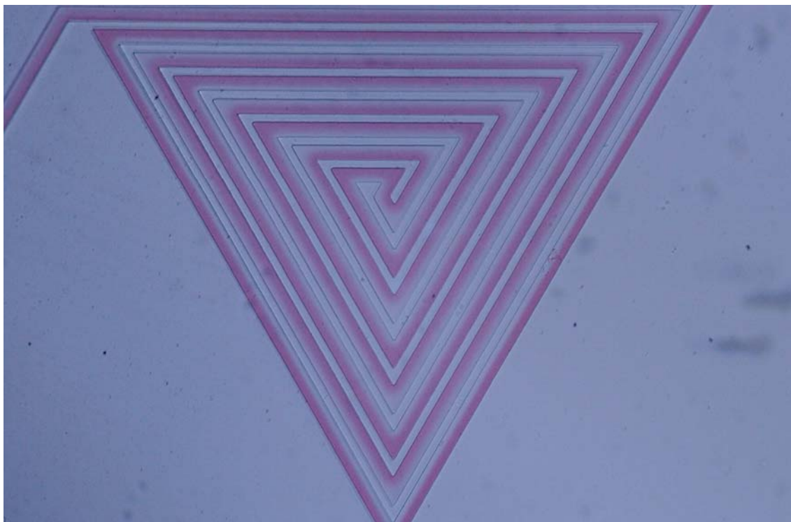
圖 3-11a，三角形微混合器， Re=0.01 。
