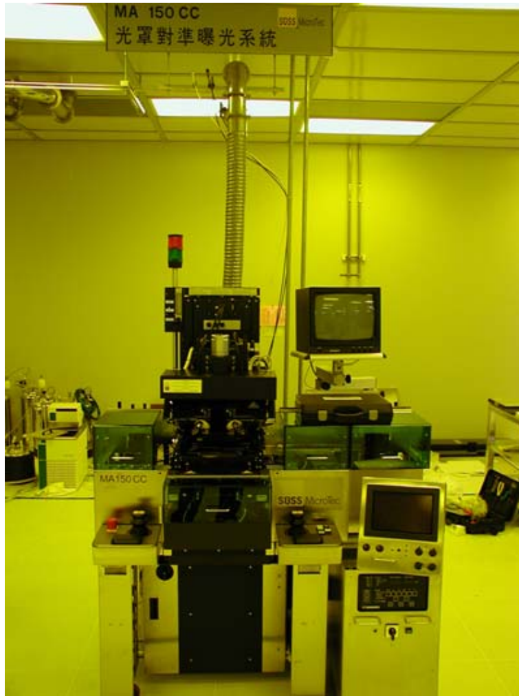
圖 2-5，光罩對準曝光系統(Mask aligner)。
