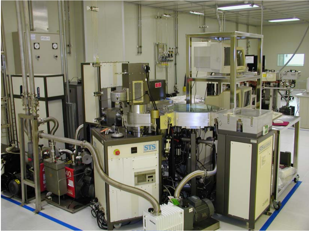
圖 2-7，反應式離子蝕刻系統(STS-RIE)。
