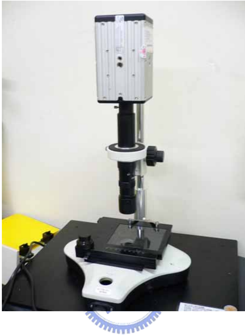
圖 2-18 顯微實驗平台與高速攝影機
