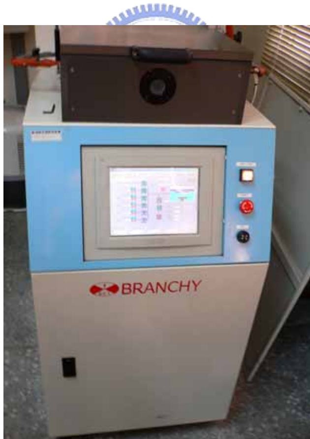
圖 2-10 反應式離子蝕刻機(Reactive Ion Etching)
